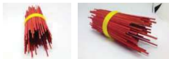
ภาพที่ 5 ก้านรูปที่เรียงตามแม่พิมพ์และถูกพ่นด้วยสเปย์ เคลือบแข็ง
