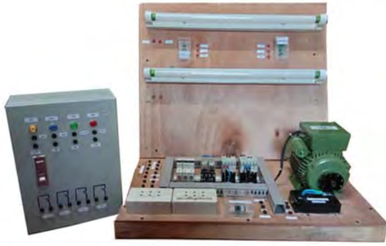
รูปที่ 7 ชุดทดลองการควบคุมอุปกรณ์ไฟฟ้าด้วย สมาร์ตโฟนผ่านระบบอินเทอร์เน็ต ผลการทดลองและผลการดำเนินงาน
