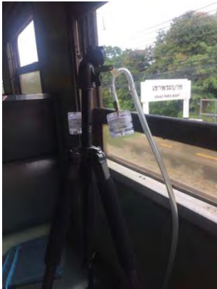
ภาพที่ 1 ติดตั้งปั๊มเก็บตัวอย่างแบบติดตั้งส่วนบุคคล (Personal Pump) ในตู้โดยสารรถไฟธรรมดา
