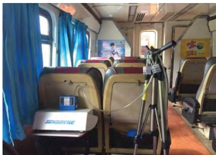
ภาพที่ 2 ติดตั้งปั๊มเก็บตัวอย่างแบบติดตั้งส่วนบุคคล (Personal Pump) ในตู้โดยสารรถไฟปรับอากาศ
