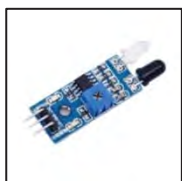
ภาพที่ 5 เซ็นเซอร์ตรวจจับแบบอินฟราเรด [7]
