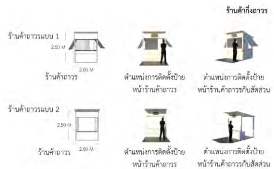
ภาพที่ 17 ตำแหน่งติดตั้งป้ายร้านค้ากึ่งถาวร
